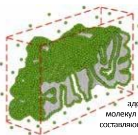
2 Вид монослоя адсорбированных молекул при насыщении, составляющем около 20%.
