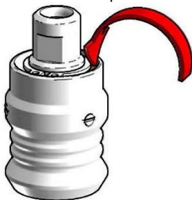
Рис. 29: Капельный ввод растворителя в соединение
