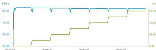
Рисунок 2: Онлайн-график одного измерения сиропа от кашля А. Доступно для ViscoQC 300 с дополнительным обновляемым пакетом программ V-Curve.
