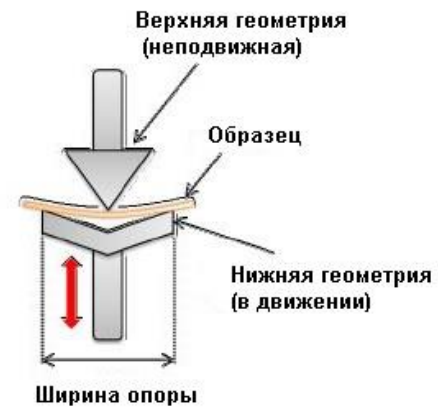
Рисунок 3: Схематическая иллюстрация трехточечного испытания на изгиб. Деформация образца увеличена.
