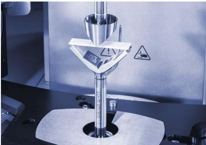
Рисунок 2: Трехточечная геометрия изгиба (расстояние опоры 40 мм)
