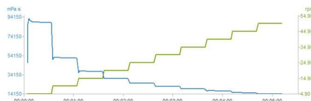
Рисунок 1: График в режиме реального времени - вязкость майонеза, измеренная на разных скоростях с использованием ViscoQC 300 - H с V-Curve.
