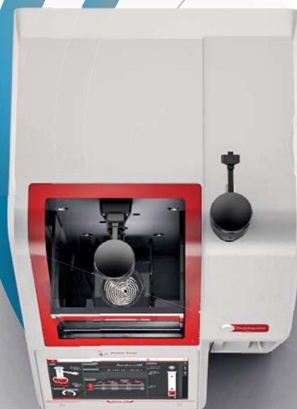
Дистилляция при атмосферном давлении - это важный тест для оценки содержания различных групп нефтепродуктов в сырой нефти, основанный на определении диапазонов температур кипения. Исследование фракционного состава также дает информацию о свойствах и поведении нефтепродуктов при хранении и использовании. Помимо этого, дистилляция определяет стандарты техники безопасности при работе с углеводородным топливом.
