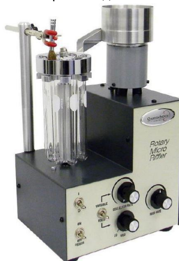
Anton Paar QuantaTec (Quantachrome) Rotary Micro Riffler. Прибор позволяет точно отбирать грубые и гетерогенные сухие порошки, что является необходимым условием для их измерения методом лазерной дифракции в сухом режиме.
