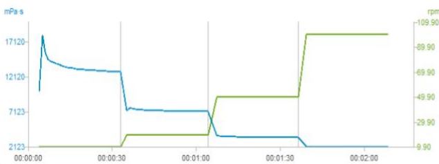
Рис. 1. Пошаговый тест образца А с ViscoQC 300 + V-Curve. Пошаговый тест включает измерения при 10, 20, 50 и 100 об / мин.
