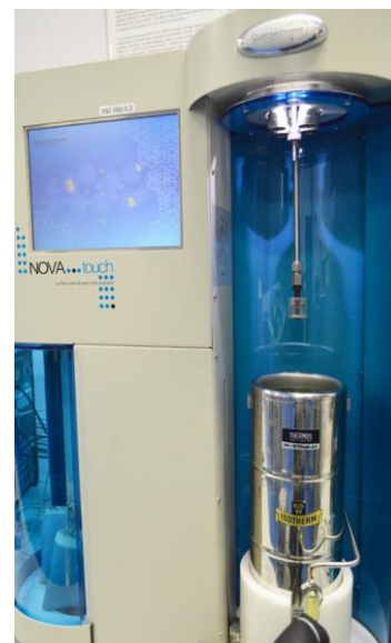
Рис. 2: NOVAtouch с рециркуляционным сосудом Дьюара и датчиком уровня для адсорбции \text{CO}_2 при 0°C
