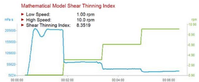
Рисунок 2: Сканирование по скорости бентонитовой глины с помощью ViscoQC 300.
