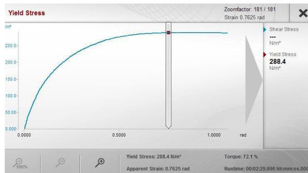
Рисунок 2: График результатов измерения статического предела текучести зубной пасты из памяти данных ViscoQC 300. Доступен только с программным пакетом V-Curve
