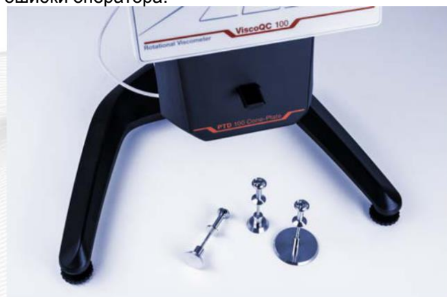
Рисунок 1 РТD 100 Конус-плоскость, установленная на ViscoQC и различные шпиндели конус-плоскость (СР).
